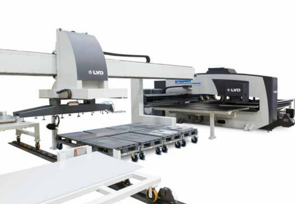
La 'Flexible Automation' (FA-P) ofrece un sistema avanzado de carga/descarga, selección de la pieza y una gran zona de apilamiento de las piezas punzonadas directamente sobre el palé destinado.
