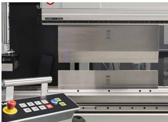
Rápida sujeción hidráulica en la trancha y en la mesa
