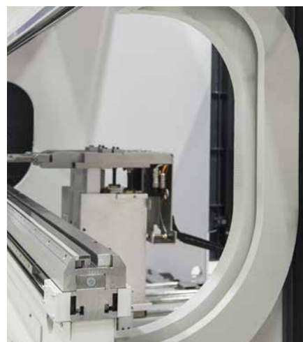
Distancia mesa-trancha/carrera de trabajo/cuello de cisne aumentada en pasos de 100 mm
