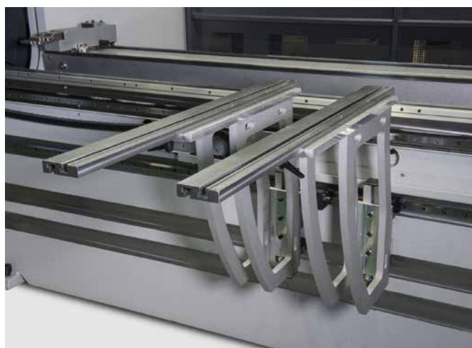
Soportes delanteros en carriles guía que permiten una rápida colocación de la chapa a lo largo de la longitud de plegado
