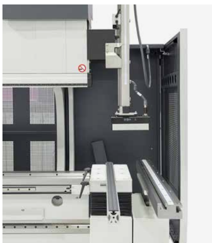
Zona de estacionamiento ampliada izquierda/derecha
